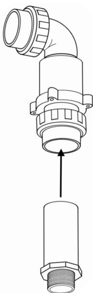
Elimine las rebabas en el corte del caño de descarga con un pequeño trozo de papel de lija. Limpie el conector hembra de 2" instalado en la parte inferior de la válvula de retención y el extremo cortado del caño de descarga con limpiador o imprimación para PVC. Aplique adhesivo para PVC e inserte el caño de descarga en el conector hembra de 2". Sujete el caño de descarga firmemente en su lugar durante unos segundos para que el adhesivo actúe.
