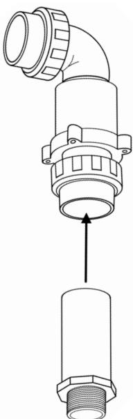
Utilisez un petit morceau de papier de verre pour éliminer les aspérités de l'extrémité coupée du tuyau d'évacuation. Nettoyez le raccord à emboîtement de 2" sur le bas du clapet anti-retour et l'extrémité coupée du tuyau d'évacuation avec un nettoyant/apprêt pour PVC. Appliquez de la colle pour PVC et insérez le tuyau d'évacuation dans le raccord à emboîtement de 2". Maintenez fermement le tuyau d'évacuation pendant quelques secondes, pour laissez le temps à la colle de prendre.
