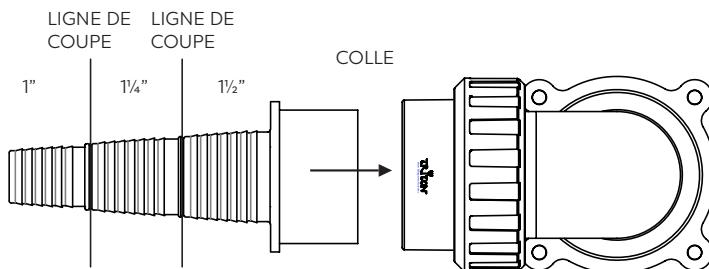
Terminez l'installation en serrant les écrous-raccords sur le clapet anti-retour Triton.
